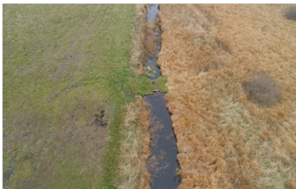
Jeden z kilku przepustów „dławiących” zastosowanych w obrębie torfowiska alkalicznego Plebanka w woj. lubelskim (fot. Robert Stańko, Klub Przyrodników)
